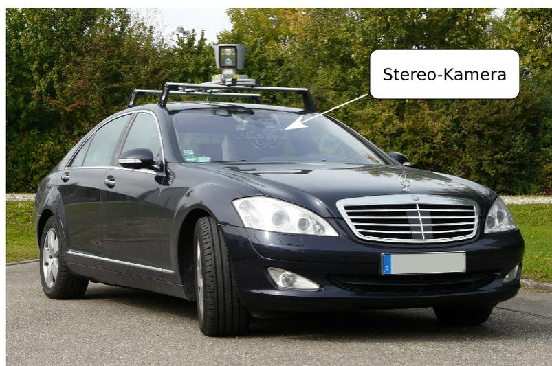
Abbildung 6.3: Versuchsträger mit Stereokameras hinter der Frontscheibe.
