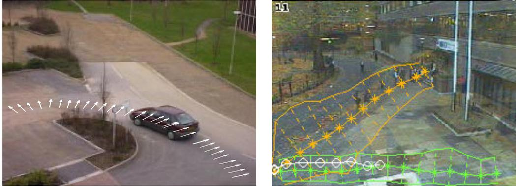
(a) Beispiel der Erkennung des Abbiegemanövers nach FRAILE und MAYBANK [1998]. Die weißen Pfeile sind Normalvektoren orthogonal zur Trajektorienrichtung. (b) Generalisierung und Inferenz von Fußgängertrajektorien. Sterne stellen die latenten Zustände mit zugehörigen Unsicherheiten dar. Quelle: MAKRIS und ELLIS [2002]
